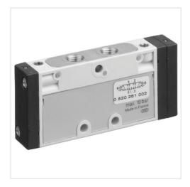
Bauart Schieberventil, überschneidungsfrei Betätigung pneumatisch Vorsteuerung extern weich dichtend Dichtprinzip 700 l/min Durchflusswert Qn Betriebsdruck min./max. -0,9 ... 10 bar 3 ... 10 bar Steuerdruck min./max. -10 ... 50 °C Umgebungstemperatur min./max. -10 ... 50 °C Mediumstemperatur min./max. Druckluft Medium 5 µm Max. Partikelgröße Ölgehalt der Druckluft 0 ... 5 mg/m<sup>3</sup>
