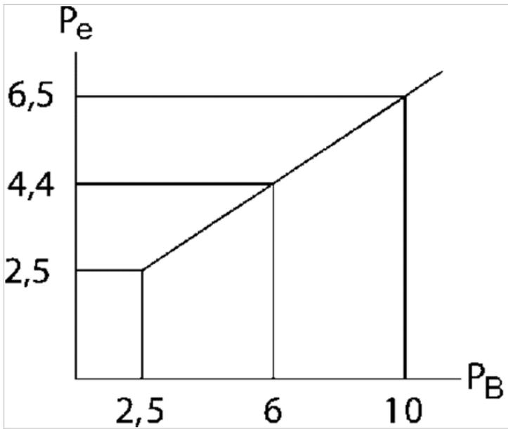
$P_e$  = externer Steuerdruck, min.  $P_B$  = Betriebsdruck
